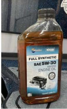
**NEVER REUSE OIL. ONLY NEW OIL SHOULD BE USED. ONLY 5W30 SYNTHETIC DEXOS™ GEN2 ENGINE OIL SHOULD BE ADDED TO THE OIL SYSTEM OF AN M-SERIES ENGINE AND 0W40 FOR AN LT4 ENGINE.**
